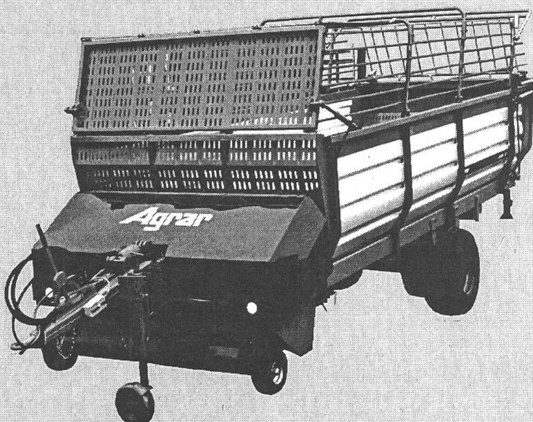
Die neuen Ladewagen AGRAR Jumbo 350/420 sind eine Weiterentwicklung der bewährten Hochlader und sind für Ladekapazitäten von 35 m<sup>3</sup> bzw. 42 m<sup>3</sup> bestimmt. Die Bodenwellenprobleme sind mit dem Pendel-Pic-up behoben und für schonende
