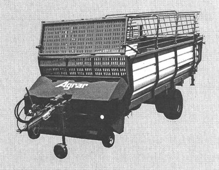
Die neuen Ladewagen AGRAR Jumbo 350/420 sind eine Weiterentwicklung der bewährten Hochlader und sind für Ladekapazitäten von 35 m3 bzw. 42 m3 bestimmt. Die Bodenwellenprobleme sind mit dem Pendel-Pic-up behoben und für schonende
