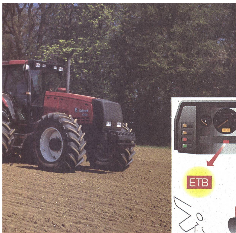
Valmet 8750: Eine elektronische Rückkoppelung \Sigma -Power erhöht die Leistung des 6-Zylinder-Motors bei hohem Drehmoment an der Zapfwelle.
