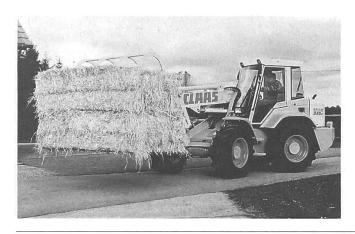
Transporte und Ladearbeiten auf dem Hof sind die Einsatzgebiete des neuen Claas Ranger 940 GX. Die komfortable Knicklenker-Maschine zeichnet sich durch ein besonderes Konstruktionsprinzip aus: den zentral gelegenen Arbeitsarm.
