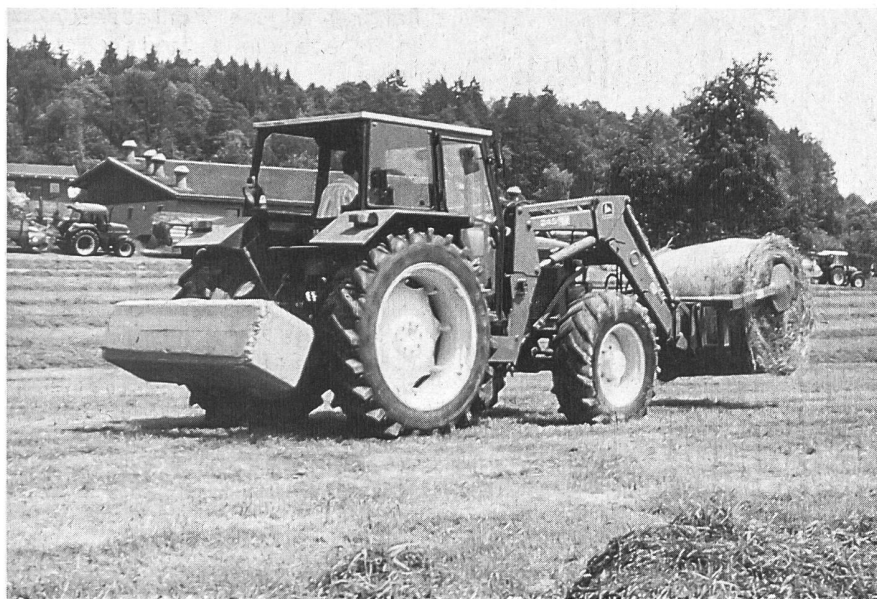
Ein Zusatzgewicht an der Heckhydraulik entlastet die Vorderachse.
