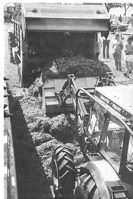
Silageverteilen im Fahrsilo bedingt ebenso wie Erdarbeiten doppeltwirkende Hydraulikzylinder.
