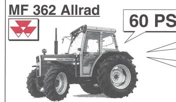
mit DE LUXE Kabine mit 4-Zylinder Perkins Motor mit 18/6-Speedshift Getriebe mit Seitenschaltung
