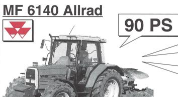
mit elektrohydraulischer Reversierung mit neuer Komfort Kabine (72 dba) mit 4-Stufen-Dynashift-Lastschaltgetriebe mit Fahrkupplung im Ölbad
