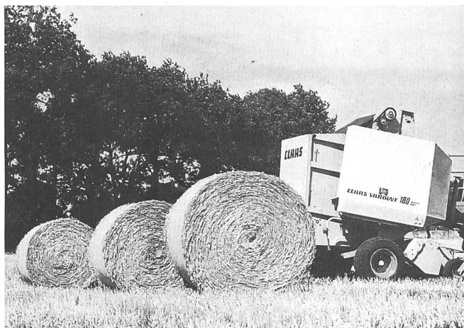
Der Schlepperfahrer kann jederzeit erkennen, wie gross der Ballen in der Presse ist, denn eine Anzeige signalisiert ihm ständig den gegenwärtigen Ballendurchmesser. Ob durch und durch feste Silageballen zu pressen oder Heuballen mit einem etwas weicheren Kern zur besseren Durchlüftung gefordert sind, die Dichte kann
