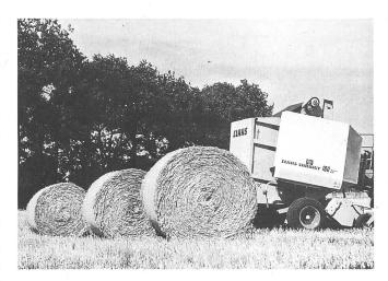
Der Schlepperfahrer kann jederzeit erkennen, wie gross der Ballen in der Presse ist, denn eine Anzeige signalisiert ihm ständig den gegenwärtigen Ballendurchmesser. Ob durch und durch feste Silageballen zu pressen oder Heuballen mit einem etwas weicheren Kern zur besseren Durchlüftung gefordert sind, die Dichte kann
