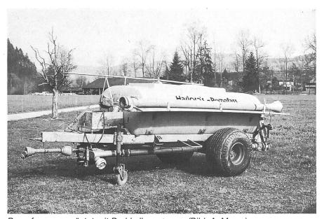
Pumpfass ausgerüstet mit Drehkolbenpumpe. (Bild: A. Moser)
