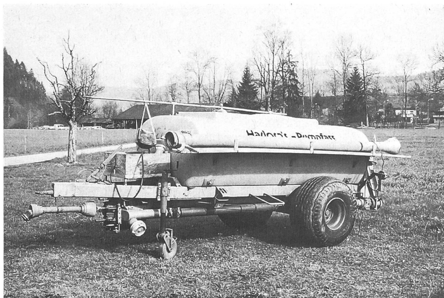
Pumpfass ausgerüstet mit Drehkolbenpumpe. (Bild: A. Moser)
