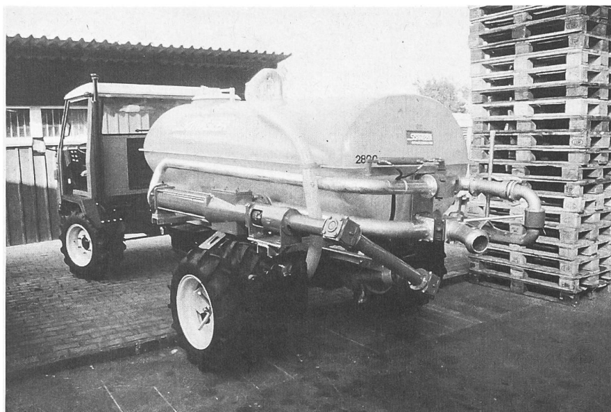
Vielseitige Einsetzbarkeit des Pump-Druckfasses. Bedienung mittels Hydraulikzylinder. (Photo: Zw.)
