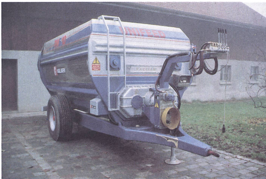
Hohe Stützlast: Futtermischwagen werden konsequent für Untenanhängung konstruiert. (Photos: SVLT)
