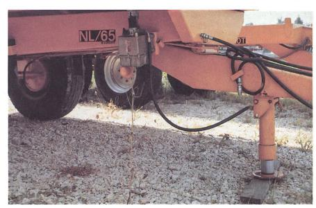
Hydraulisch verstellbare Stütze an Muldenkipper.
