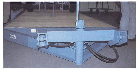
Hohe Stützlasten können von den Unterlenkern aufgenommen werden, Beispiel Längsvorrichtung.
