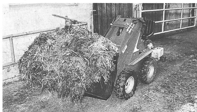
Abb. 8. Versuch Strickhof. Die Entmistung des Laufhofs erfolgt mit dem Kleinlader. Eine Lösung mit Schieber und Mistlager beim Stall wäre arbeitswirtschaftlich besser.
