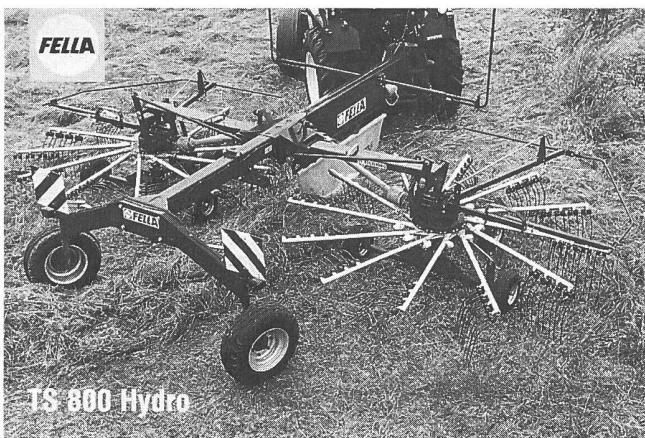
Diese gezogenen Doppelschwader mit Unterlenkeranhang sind in verschiedenen Arbeitsbreiten bis zu 8,40 m lieferbar.
