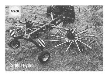
Diese gezogenen Doppelschwader mit Unterlenkeranhängung sind in verschiedenen Arbeitsbreiten bis zu 8,40 m lieferbar.
