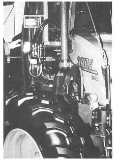
Arbeitsplatzsystem «Traktor»: Voraussetzung für den ausserordentlich vielseitigen Einsatz sind die verschiedenen Anbauräume mit mechanischen, elektrischen und hydraulischen Kupplungspunkten.
