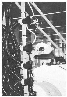
Sprayer für den Obstbau mit Photosensorik für das Erkennen, ob Blattwerk vorhanden ist oder fehlt und entsprechender Steuerung der benachbarten Düse.
