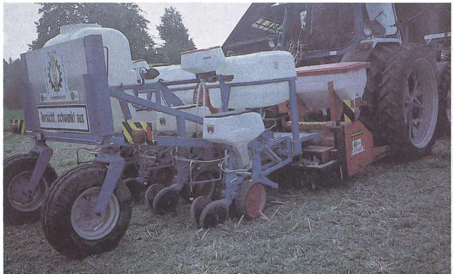
Gerätetechnik der neuesten Generation nach Witzig mit Stützrädern zur Achsentlastung auf dem Traktor. Behälter für N-Düngung, Granulat und für separate Unkrautregulierung in und zwischen den Reihen.
