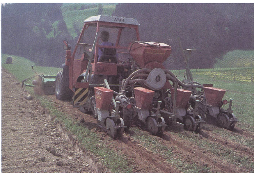
Gerätetechnik der neuesten Generation nach Witzig mit Stützrädern zur Achsentlastung auf dem Traktor. Behälter für N-Düngung, Granulat und für separate Unkrautregulierung in und zwischen den Reihen.
