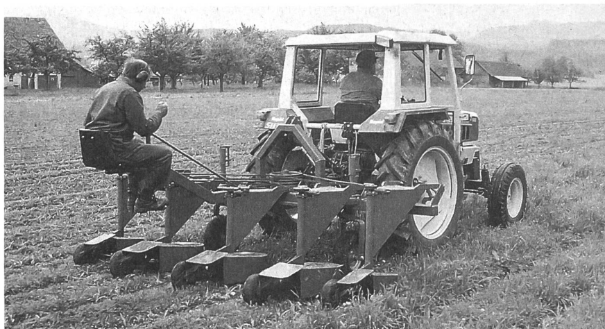
Mulchverfahren: Prototyp eines Sichelmähers (nicht den Sicherheitsanforderungen entsprechend).
