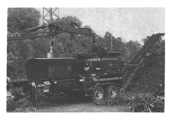
Motor hat eine Stundenleistung bis 100 m³ geschreddertes Material, ohne dass die Maschine verschoben werden muss. Die Zerkleinerung ist perfekt. Das Endprodukt hat eine konstante, gleichbleibende Grösse und wird mittels Förderband ausgetragen und auf LKW, Anhänger oder Lagermieten abgelegt.
