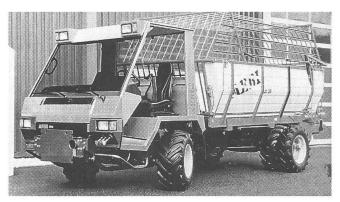
Der neuentwickelte Aebi-Transporter erspart dem Benützer dank der neuen Luftfederung und weiteren wegweisenden Komfortelementen alle unnötigen Strapazen. Er bietet viel mehr Nutzlast, ein neues Getriebe und einen 52°-Lenkeinschlag.
