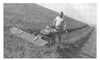
Der neue Eingrasmäher Aebi AM 42 mit Aktivlenkung, hydrostatischem Fahrantrieb und variabler Gewichtsverteilung. Auch erhältlich mit dem robusten und kostengünstigen Gabelmahdenformer.
