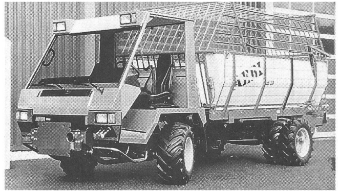
Der neu entwickelte Aebi-Transporter erspart dem Benutzer dank der neuen Luftfederung und weiteren wegweisenden Komfortelementen alle unnötigen Strapazen. Er bietet viel mehr Nutzlast, ein neues Getriebe und einen 52°-Lenkeinschlag.
