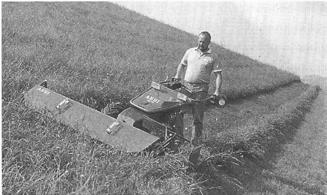
Der neue Eingrasmäher Aebi AM 42 mit Aktivlenkung, hydrostatischem Fahrtrieb und variabler Gewichtsverteilung. Auch erhältlich mit dem robusten und kostengünstigen Gabelmahdenformer.
