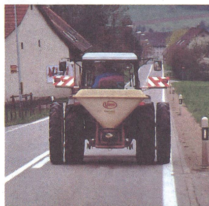
Dank Doppelradmarkierung ist die Gesamtbreite des Fahrzeuges auf den ersten Blick erkennbar.
