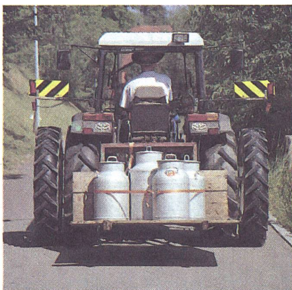
Dank Doppelradmarkierung ist die Gesamtbreite des Fahrzeuges auf den ersten Blick erkennbar.
