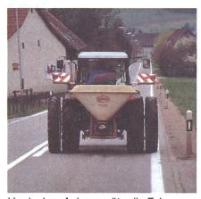
Verdecken Anbaugeräte die Fahrzeugbeleuchtung, bieten Doppelradmarkierungen kombiniert mit der Schlusslicht-/Blinkanlage eine unabdingbare Sicherheit.
