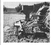
Neu: Säkombination für Getreide, Raps, Grasmischungen usw. mit Pneupacker und Saatstriegel
