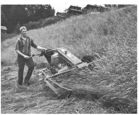
Der breite Radstand und die Bremslenkung erleichtern die Bedienung des Bergmähers.
