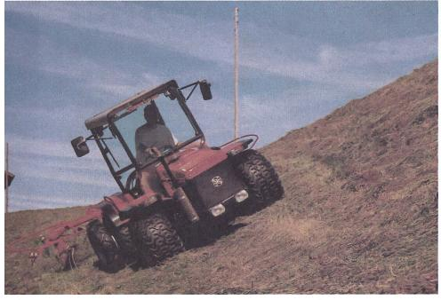
beim Kreiselschwader, dafür muss man beim Einsatz des Bandrechens nicht über das Futter fahren, und durch den nahen Anbau ist auch die Sicherheit am Hang bei leichten Zugmaschinen besser gewährleistet.
