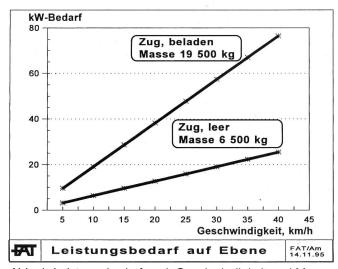
Abb. 1 Leistungsbedarf nach Geschwindigkeit und Masse.
