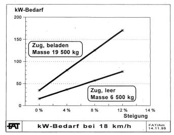
Abb. 2 Leistungsbedarf in Abhängigkeit von Steigung und Masse.
