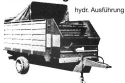
Diverse Modelle: 1- und 2-Achser oder Tandem, vor- und rückwärts laufender Kratzboden, beidseits laufendes Gummiförderband, drei Dosierwalzen.
