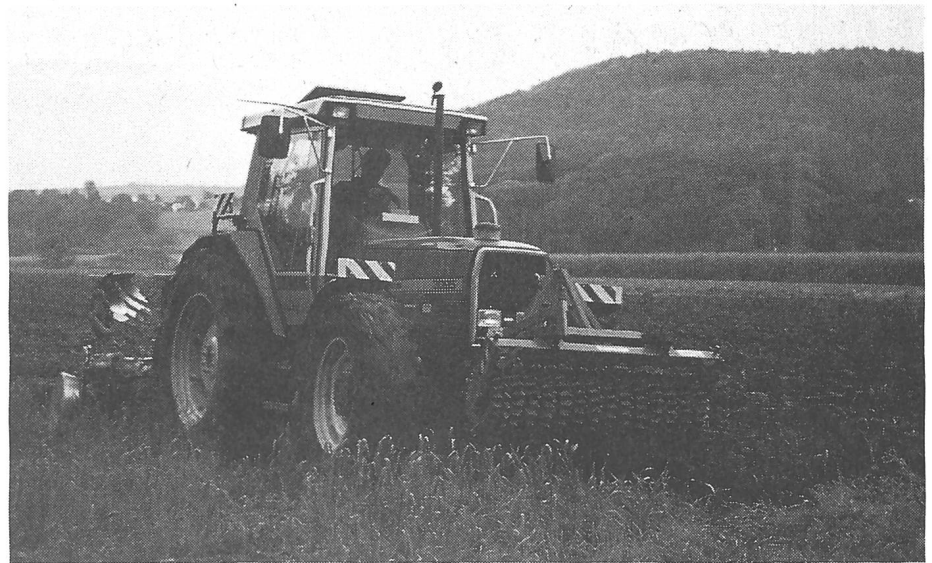
Nebeneffekt des Zusatzgerätes: Sicherer Bodenkontakt der Lenkachse.
