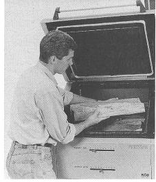
Stückholzkessel mit grosser oberer Fülltüre für eine einfache Holzbeschickung. (Foto: KÖB)
