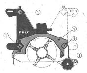
den Y-Messern (Sonderausrüstung) wird die Schnittleistung in Ernterückständen und beim Mulchen von Grünbracheparzellen erhöht.
