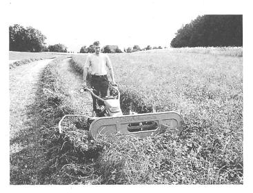
passung, verleiht dieser Maschine eine überdurchschnittliche Hangtauglichkeit und zeichnet sich durch eine verringerte Aushebekraft am Holm aus. Ebenfalls patentiert ist der neue Rapid-Parallel-Messerantrieb, welcher spielfrei und deshalb äusserst verschleissarm arbeitet. In Kombination mit dem stufenlosen, hydrostatischen Fahrantrieb bietet die neue Rapid-Eingraser-Generation ein Höchstmass an Bedienungskomfort und Sicherheit.
