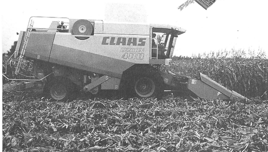
LEXION 480 mit achtreihigem Maisgebiss im Feldeinsatz. Deutlich erkennbar der hochklappbare Tank und der hintenliegende Motor. (Bild Zw.)
