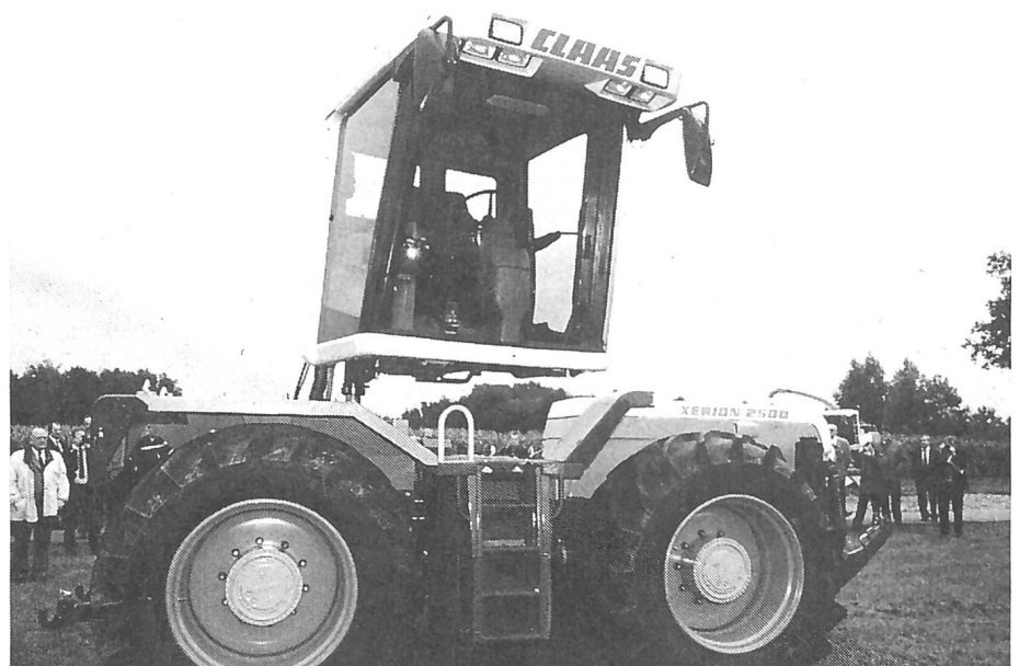
High-Tech-Schlepper XERION: Die Kabine wird in die neue Position geschwenkt.
