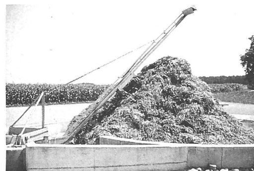
Die Hochförderanlage bietet bei allen Mistarten eine hohe Funktionssicherheit und ist relativ kostengünstig.
