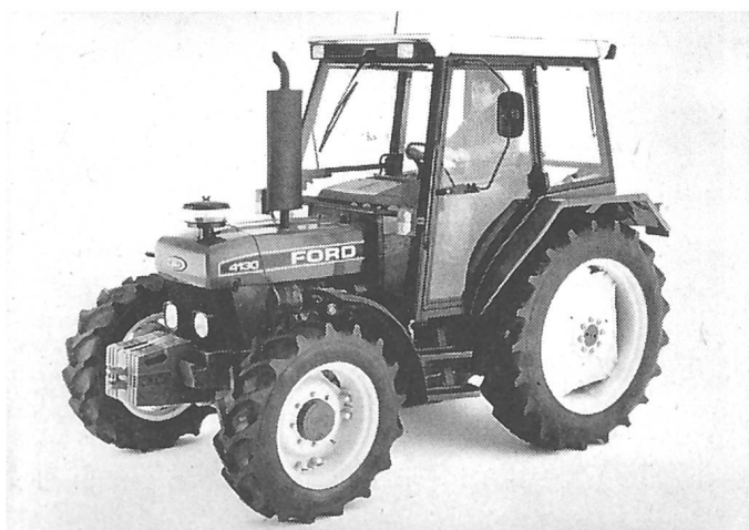
New Holland Ford Serie 30: Der Pflegeaktor mit synchronisiertem Dualpower-Wendegetriebe.
