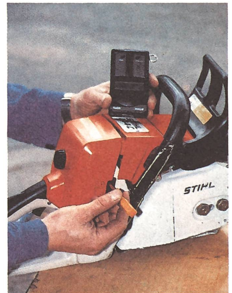
Der Vergaser lässt sich nur in Verbindung mit einem elektronischen Drehzahlmessgerät richtig einstellen.
