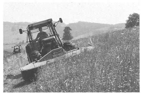
Hohe Schlagkraft mit Frontmähwerk und Aufbereiter.
