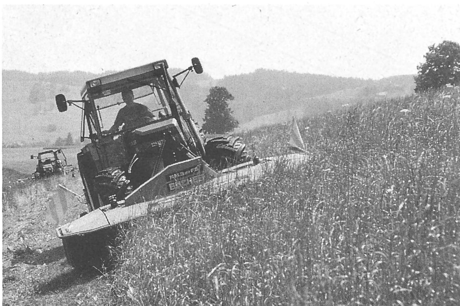
Hohe Schlagkraft mit Frontmäherwerk und Aufbereiter.
