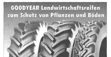
Super Traction Radial/DT 810 DT 820 Verstärkte, robuste Profilstollen für kompromisslosen Einsatz bei schwierigen Verhältnissen.
