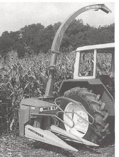
für 100%igen Körneraufschluss 4 mögliche Schnittlängen 3,5/4/7/9 mm, je nach Reifegrad Zapfwellenantrieb schaltbar mit Durchtrieb Schrägstehender Auswurf für optimale Auswurfleistung Verstellbare Tragzapfen auch für grosse Traktoren Lange Torpedos
