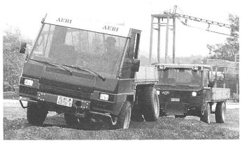
Der neue Aebi-Transporter und «Kleinstlastwagen» TP 98 im unwegsamen Gelände. Dank der neuen Luftfederung und weiteren wegweisenden Komfortelementen entstehen für den Fahrer keine unnötigen Strapazen mehr.
