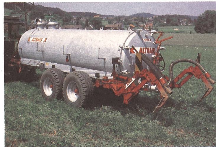
Gülleeinleger. Der Radabstand ist bei Althaus genau auf den Mais-Reihenabstand abgestimmt.
