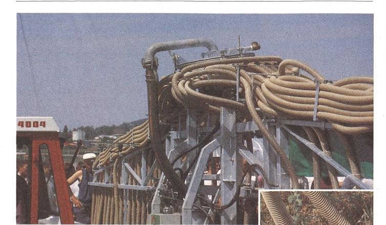
Gülletransport und Zwischenlagerung getrennt vom Ausbringsystem z.B. Schleppschlauchsysteme mit 12 Meter Arbeitsbreite ...
