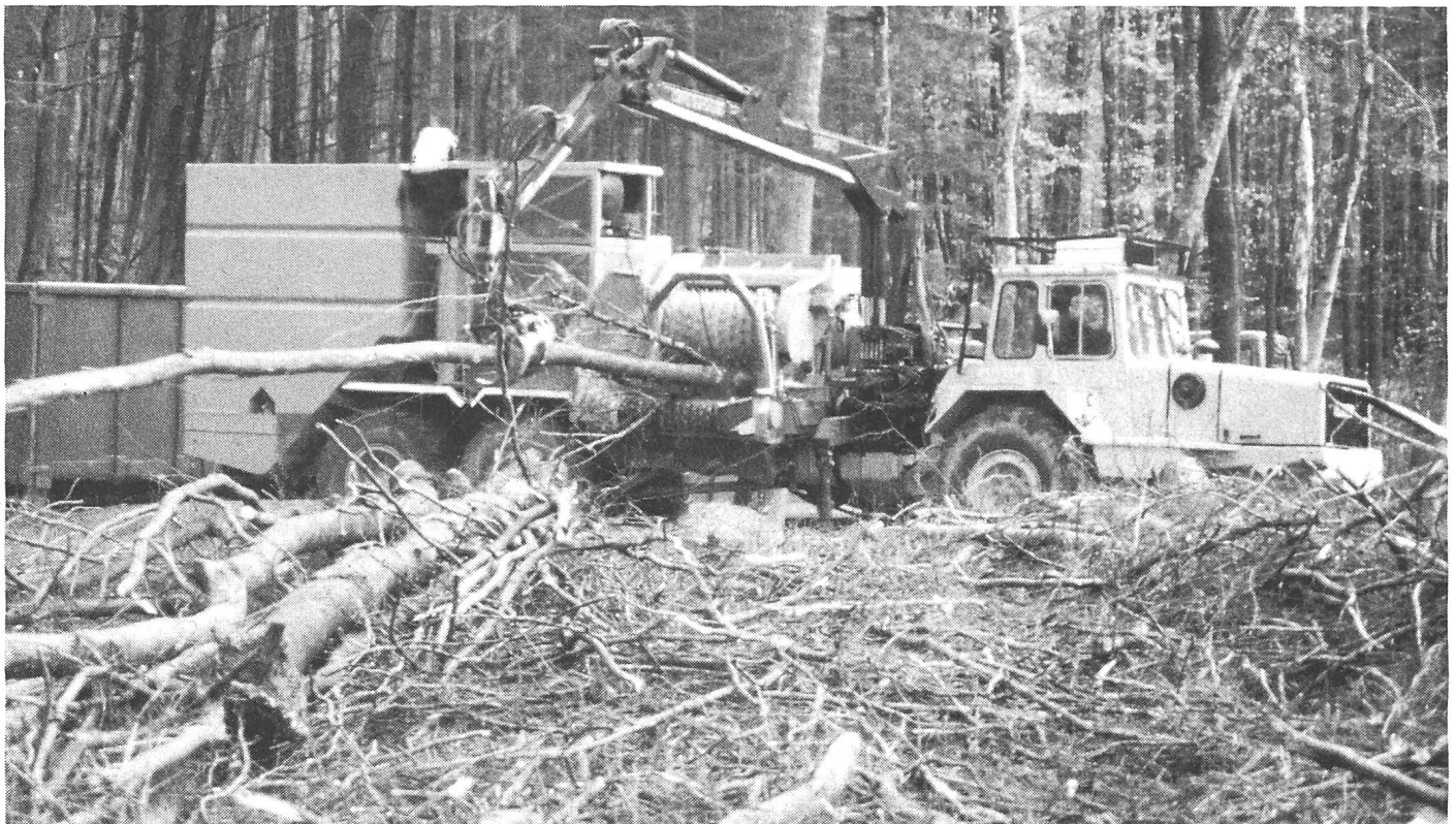
Mobiler Trommelhacker aufgebaut auf BM-Volvo. Die optimierte Arbeitsorganisation hat einen grossen Einfluss auf die Stundenleistung, die zwischen 50 und 100 Kubikmeter Schnitzel schwankt.
