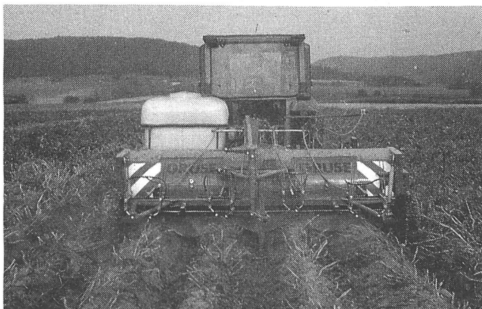
Abb. 2. Das Krautschlagen und die Bandspritzung mit je zwei Düsen «Teejet OC-02» pro Reihe waren in allen Versuchsjahren erfolgreich (60% Präparateinsparung, Schläger mit Krautablage in Furchen).
