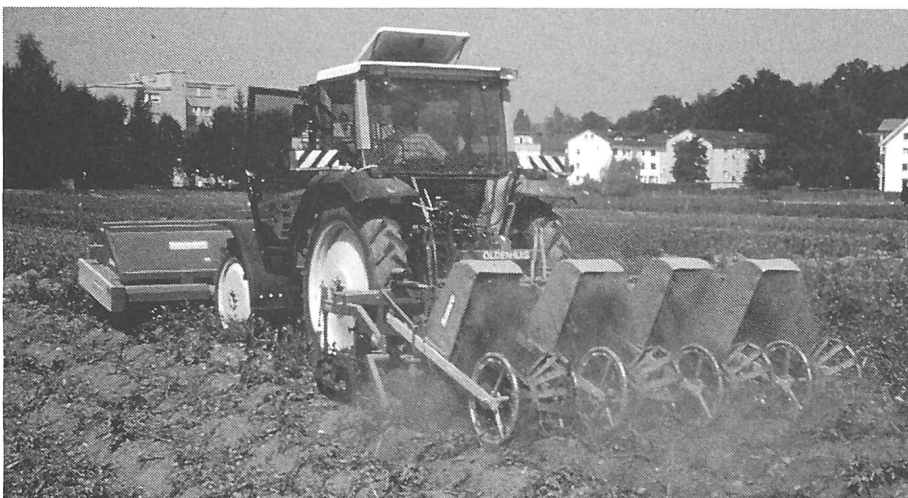
Abb. 1. Mit der Kombination Krautschläger mit -ziehmaschine wird das abgeschlagene Kraut in den Furchen abgelegt und die Reststengel mit den Luftgummirollen herausgezogen (Traktor 61 kW Allrad, 11-Zoll-Bereifung, Zapfwelle 1000 U/min, Hürlimann 488 DT, 3610 kg + 1985 kg Schläger und Ziehmaschine Oldenhuis, Samro Burgdorf).
