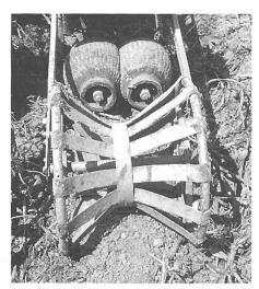
Abb. 1. Mit der Kombination Krautschläger mit -ziehmaschine wird das abgeschlagene Kraut in den Furchen abgelegt und die Reststengel mit den Luftgummirollen herausgezogen (Traktor 61 kW Allrad, 11-Zoll-Bereifung, Zapfwelle 1000 U/min, Hürlimann 488 DT, 3610 kg + 1985 kg Schläger und Ziehmaschine Oldenhuis, Samro Burgdorf).
