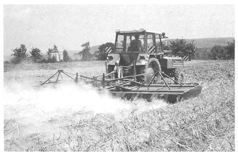
Abb. 4. Das Abflammgerät Schaffner (980 kg) wurde mit einem 40-kW-Geräteträger eingesetzt. Das flüssige Propangas wird in 24 Brenner elektrisch gezündet und verbrannt. Die gute Abbrenn-Wirkung wird allerdings durch mehrere unerwünschte «Nebenwirkungen» wie Rauchemissionen usw. begleitet.
