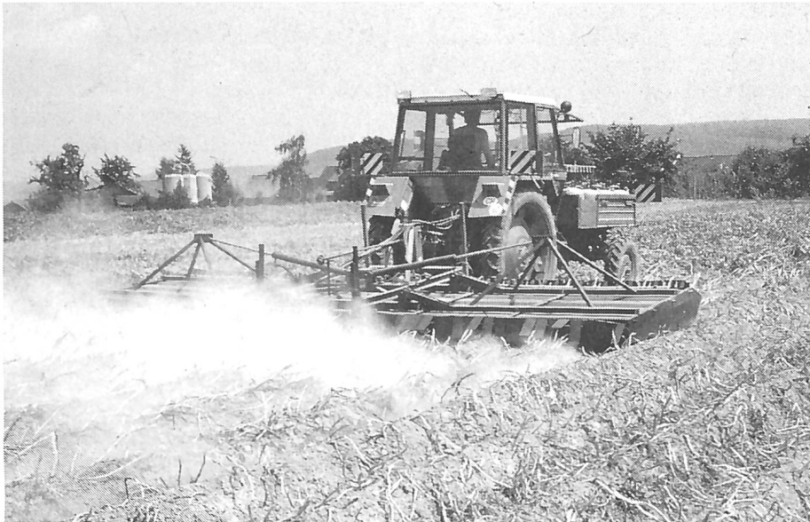
Abb. 4. Das Abflamngerät Schaffner (980 kg) wurde mit einem 40-kW-Geräträger eingesetzt. Das flüssige Propangas wird in 24 Brenner elektrisch gezündet und verbrannt. Die gute Abbrenn-Wirkung wird allerdings durch mehrere unerwünschte «Nebenwirkungen» wie Rauchemissionen usw. begleitet.
