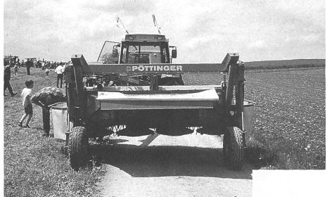
Der gezogene Scheibenmäher CAT NOVA, eine leistungsfähige Maschine mit drei Metern Arbeitsbreite. Auf der Strasse zählt der gezogene Scheibenmäher zu den Ausnahmefahrzeugen (Arbeitsanhänger bis 3 m). Sie erhalten für die Strassenfahrt ein braunes Kontrollschild.
