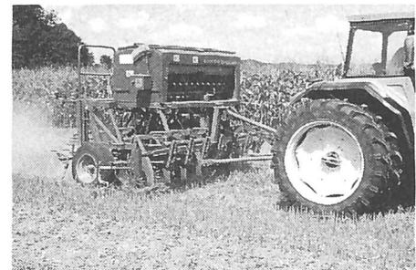
Gezeigt wird die Amazone-Direktsämaschine mit Meisselscharen. Bei der Stoppelbearbeitung sind unter anderen folgende Geräte im Einsatz: Grubber mit Nachläufer, Spatenrolle, Dyna-Drive und Parapflug sowie der OnLand-Pflug als Alternative.
