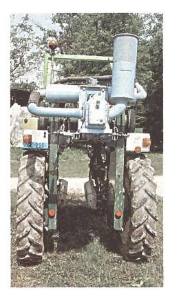
Derot-Stelzentraktor mit aufgebautem Kompressor ...
