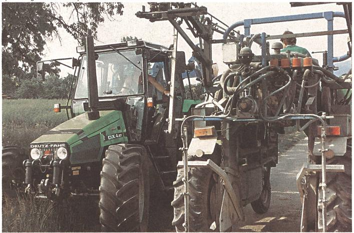
bautem **Laubschneider.** In drei Durchgängen werden die aufgehefteten Rebschosse zurückgeschnitten, damit die Trauben für den Reifungsprozess optimale Voraussetzungen erhalten.
