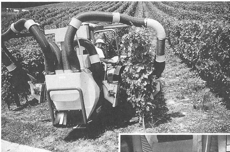
Schneidapparat für die Laubarbeit mit Sonar-Steuerung des Schneidkopfes.
