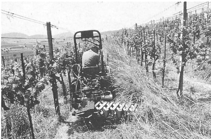
Technisch anspruchsvoller Böschungs-Mähapparat, dem auch sehr hohes Gras nicht zuviel ist.
