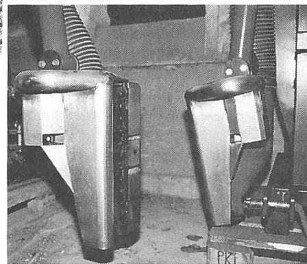
Schneidapparat für die Laubarbeit mit Sonar-Steuerung des Schneidkopfes.
