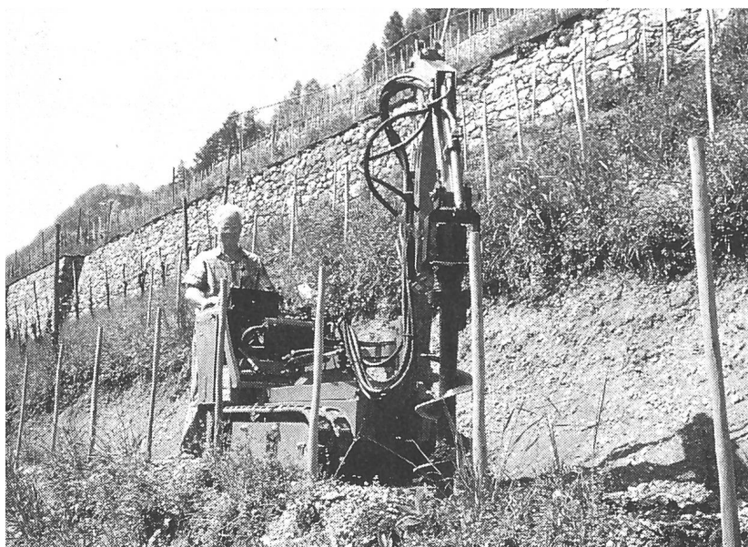
Silent-Trac CH 80 mit Universalarm und Pflanzlochbohrer.
