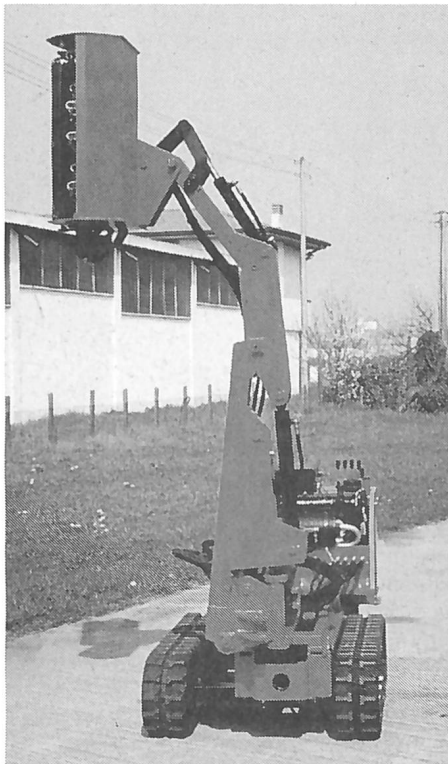
Prototyp eines Schlegelmulcher für den Böschungseinsatz.
