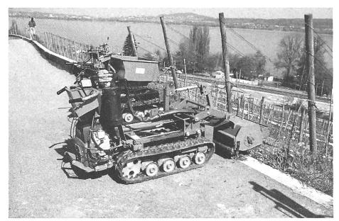
Raupe der Firma Avidor mit Mulchgerät.
