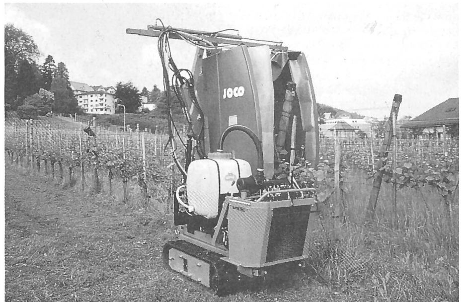
Die Tunnelspritztechnik bietet die beste Gewähr für die maximale Applikation beziehungsweise die geringste Abdrift.
