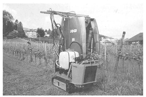
Die Tunnelspritztechnik bietet die beste Gewähr für die maximale Applikation beziehungsweise die geringste Abdrift.
