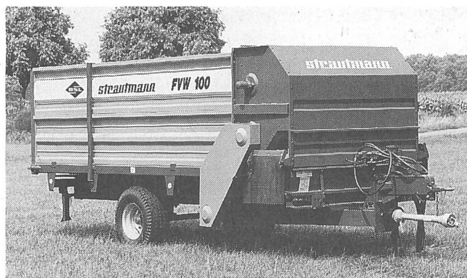
Strautmann-Futterverteilmwagen mit hydraulisch angetriebenem Kratzboden und Querförderband.
