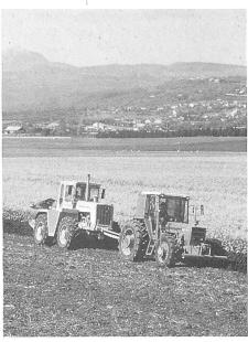
Bestimmung der Kraftübertragung und des Schlupfes auf der Laboranlage und ... im Testgelände. Der Schlupf ergibt sich aus der Differenz von Umfanggeschwindigkeit und effektiver Geschwindigkeit dividiert durch die effektive Geschwindigkeit. Er nimmt mit wachsendem Zugkraftbedarf zu und sollte 15 bis 20 Prozent nicht übersteigen. (Photos: Michelin)
