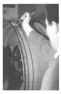
Scherwirkung am Luftventil befürchtet werden. Vorteile ergeben sich auch bei der Montage, bei der selbstredend das Einlegen des Schlauches entfällt und damit auch allfällige Schäden durch Verklemmen und durch Fremdkörper zwischen Reifeninnenwand und Schlauch. Zudem lässt sich die Wulstinnenseite des Reifens besser mit der unabdingbaren Montagepaste schmieren.
