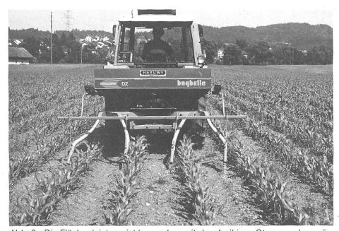
Abb. 8. Die Flächenleistung ist besonders mit den 4reihigen Streuern eher mässig und kann durch hohe Fahrgeschwindigkeiten nur teilweise kompensiert werden. Je schneller gefahren wird, desto ungenauer ist die Düngerablage (Reihenstreuer Bögballe).
