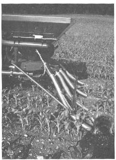
Abb. 9. Flexible Ablaufschläuche mit grossem Durchmesser haben den Vorteil, dass die Pflanzen nicht zu Schaden kommen und der Dünger im Schlauch nicht stecken bleibt. (Reihenstreuer Amazone).
