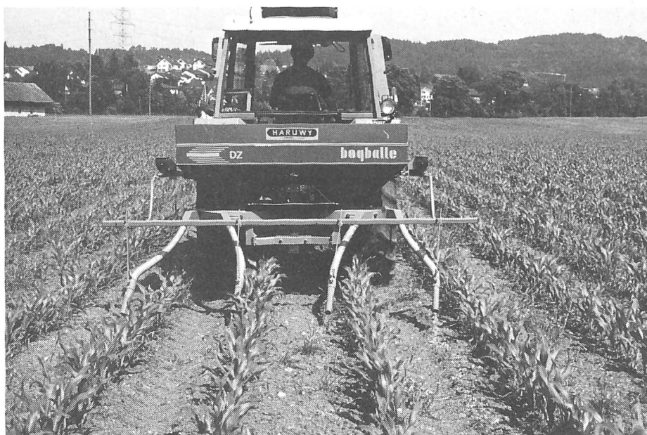
Abb. 8. Die Flächenleistung ist besonders mit den 4reihigen Streuern eher mäßig und kann durch hohe Fahrgeschwindigkeiten nur teilweise kompensiert werden. Je schneller gefahren wird, desto ungenauer ist die Düngerablage (Reihenstreuer Bögballe).
