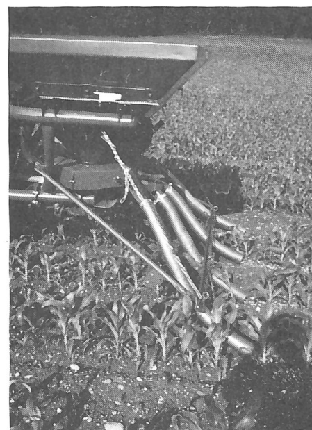
Abb. 9. Flexible Ablaufschläuche mit grossem Durchmesser haben den Vorteil, dass die Pflanzen nicht zu Schaden kommen und der Dünger im Schlauch nicht stecken bleibt. (Reihenstreuer Amazona).
