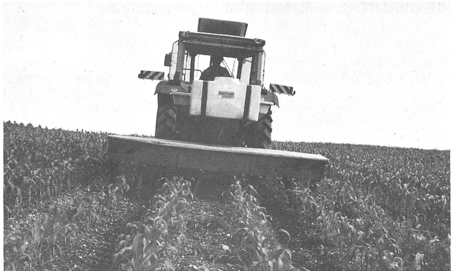
Abb. 6. Bei den Reihenstreugeräten mit Verteilkasten wird die Verteilgenauigkeit am Hang relativ stark beeinträchtigt (Reihenstreuer Vicon).
