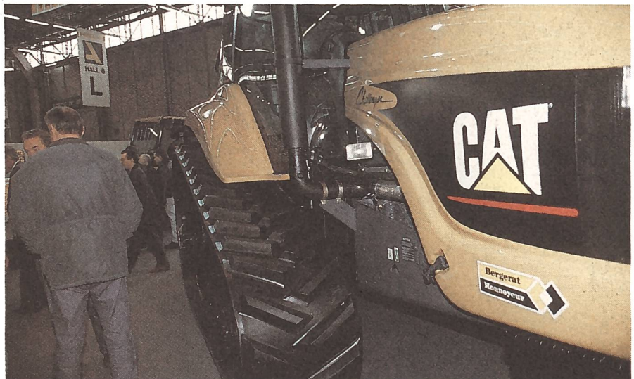
Raupen reduzieren den spezifischen Bodendruck, z.B. bei Caterpillar. (Bilder: Zw.)
