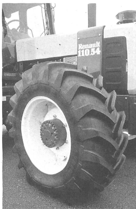
16.9 R 28 Agribib mit sehr elastischer Flankenpartie und hoher Tragkraft trotz niedrigem Reifendruck.
