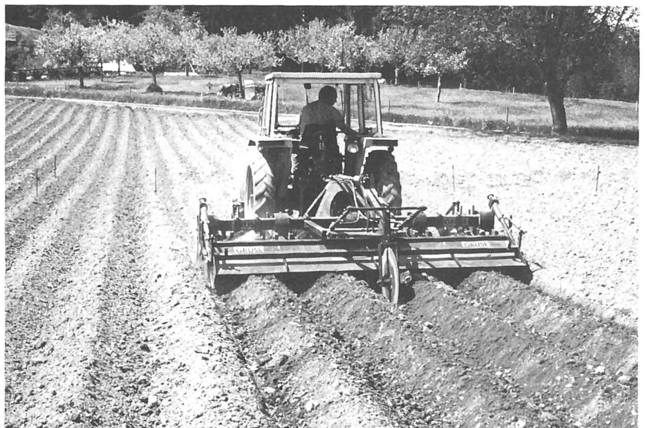
Abb. 2. Mit dem Hack- und Häufelgerät mit Dammformblech und hydraulischer Hangsteuerung können in zwei Arbeitsgängen grossvolumige Dämme aufgebaut werden. Ein 44 kW-Traktor mit Allradantrieb und 10-Zoll-Bereifung reichte auch im schweren Boden aus.
