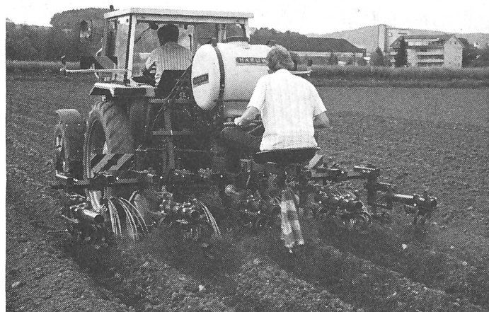
Abb. 4. Die Sternhackgeräte-Kombination zeichnete sich durch eine gute Bodenlockerung und -krümelung sowie eine wirksame Unkrautregulierung aus. Erster und dritter Arbeitsgang bei einer günstigen Bodenfeuchtigkeit.
