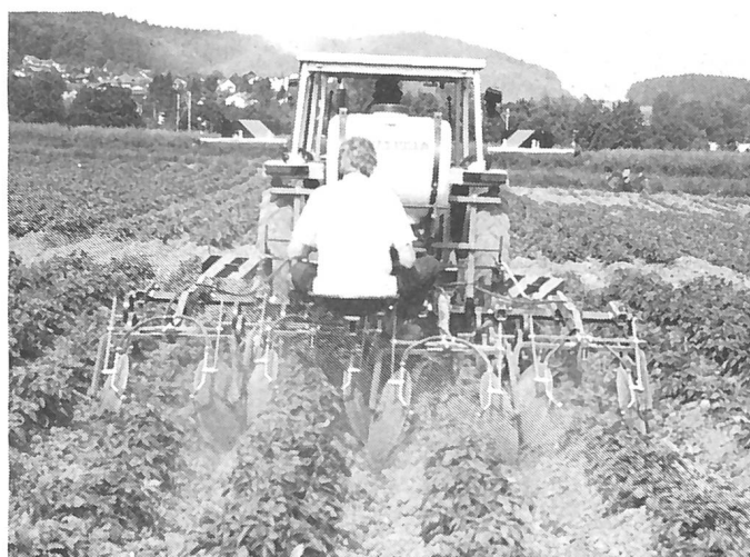
Abb. 3. Mit der Vielfachgeräte-Kombination sind Striegeln, Hacken, Häufeln und Bandspritzen in einem Arbeitsgang möglich. Erster und dritter Arbeitsgang.
