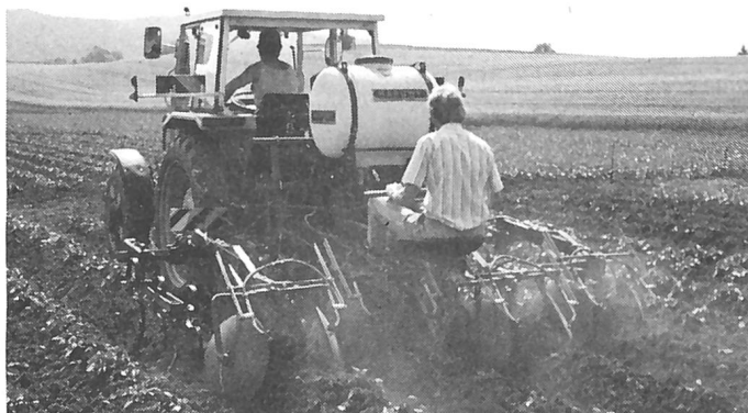
Abb. 1. Mit der Vielfachgeräte-Kombination lassen sich die drei Ziele wie Dammaufbau, Bodenpflege und eine wirksame Unkrautregulierung (rechts) erreichen.
