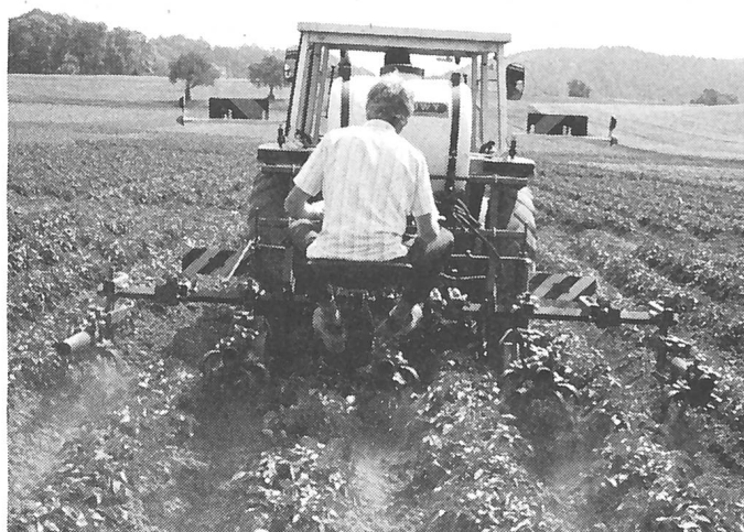
Abb. 4. Die Sternhackgeräte-Kombination zeichnete sich durch eine gute Bodenlockerung und -krümelung sowie eine wirksame Unkrautregulierung aus. Erster und dritter Arbeitsgang bei einer günstigen Bodenfeuchtigkeit.
