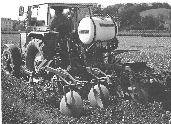
Abb. 3. Mit der Vielfachgeräte-Kombination sind Striegeln, Hacken, Häufeln und Bandspritzen in einem Arbeitsgang möglich. Erster und dritter Arbeitsgang.
