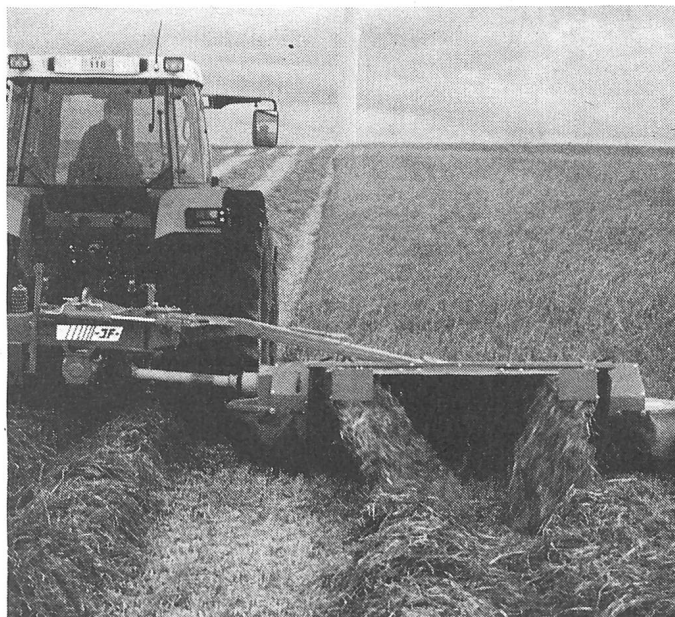
JF-CM 2650 C, 3-Punkt-Trommelmähwerk mit Aufbereiter und mit «Tandem-Schwaden», die schnell trocknen und gut für das Aufsammeln durch Rundballenpressen geeignet sind.
