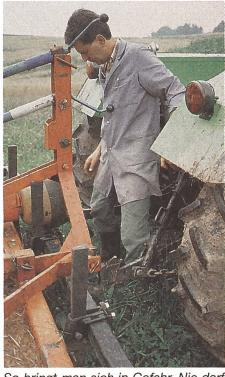
So bringt man sich in Gefahr. Nie darf die Hydraulik betätigt werden, wenn man zwischen Maschine und Traktor steht.
