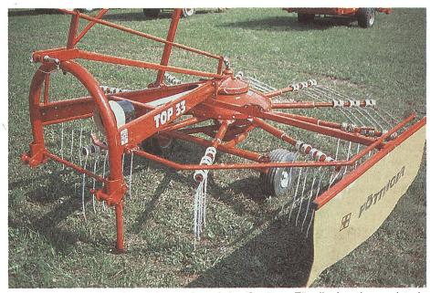
Die Stütze garantiert den sicheren Stand des Gerätes. Für die Arretierung ist ein Bolzen statt eine Klemmschraube zu verwenden.
