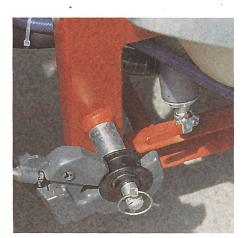
Dies ist ein Beispiel für einen schlechten Klappsplint, da er nicht an der Maschine gesichert werden kann. Sichere Klappsplinten verfügen über ein separates Loch zur Befestigung einer Kette o. ä.
