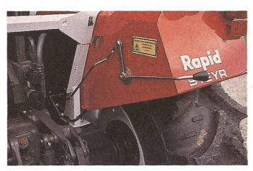
... daher sind elektronische Tippschalter vorzuziehen. Sie sollen seitlich angebracht sein, damit man für die Bedienung nicht zwischen Traktor und Gerät treten muss.
