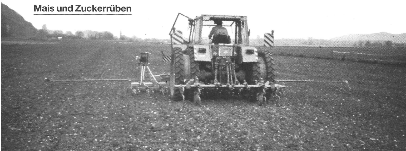
Grosse Arbeitsbreite mit mechanischer Einzelkornsämaschine dank geringem Gewicht.
