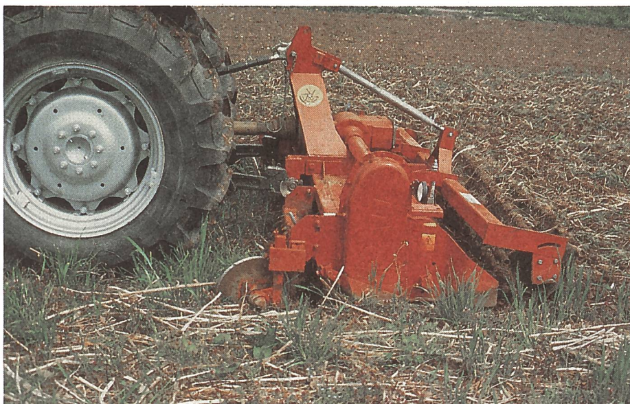
Saatbettbereitung mit Zinkenrotor für anschliessende Mulchsaat.
