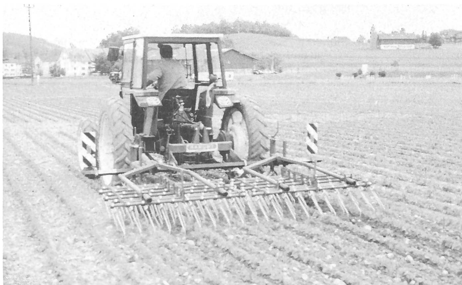
Abb. 4. Das Striegeln konnte praktisch nur in Kombination mit Hacken befriedigen. Eine mässige Fahrgeschwindigkeit, ein geringer Zinkenfederdruck und eine Arbeitskontrolle sind empfehlenswert.
