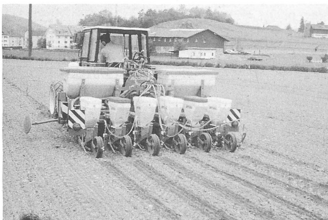
Abb. 1. Exakte Soja-Einzelkornsaat mit gleichzeitiger Herbizidbandspritzung erleichtern die Unkrautregulierung. Praktisch unkrautfreier Bestand nach zweimaligem Hacken (rechts).
