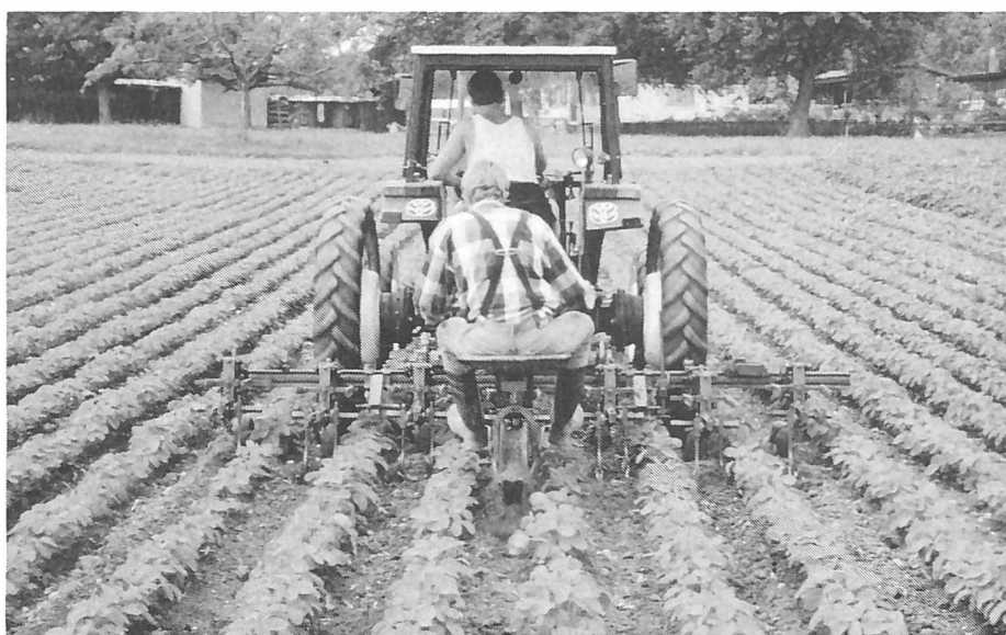
Abb. 2. Mit dem Rübenscharhackgerät lässt sich auch in Soja eine ausreichende Unkrautbekämpfung erreichen. Von links: erste bzw. zweite Durchfahrt, Hacksatzbreite 31 cm bei Winkelmesser bzw. 28 cm bei Gänsefusssscharen.
