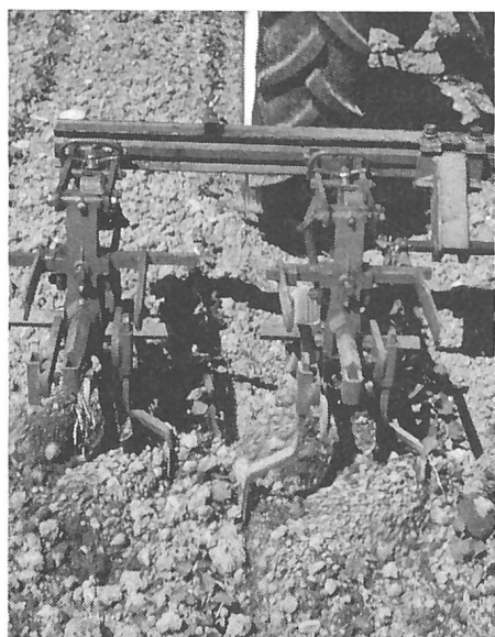
Abb. 2. Mit dem Rübenscharhackgerät lässt sich auch in Soja eine ausreichende Unkrautbekämpfung erreichen. Von links: erste bzw. zweite Durchfahrt, Hacksatzbreite 31 cm bei Winkelmesser bzw. 28 cm bei Gänsefusssscharen.
