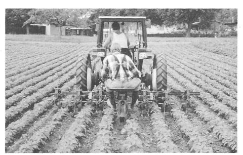
Abb. 2. Mit dem Rüben-Scharhackgerät lässt sich auch in Soja eine ausreichende Unkrautbekämpfung erreichen. Von links: erste bzw. zweite Durchfahrt, Hacksatzbreite 31 cm bei Winkelmesser bzw. 28 cm bei Gänsefussscharen.
