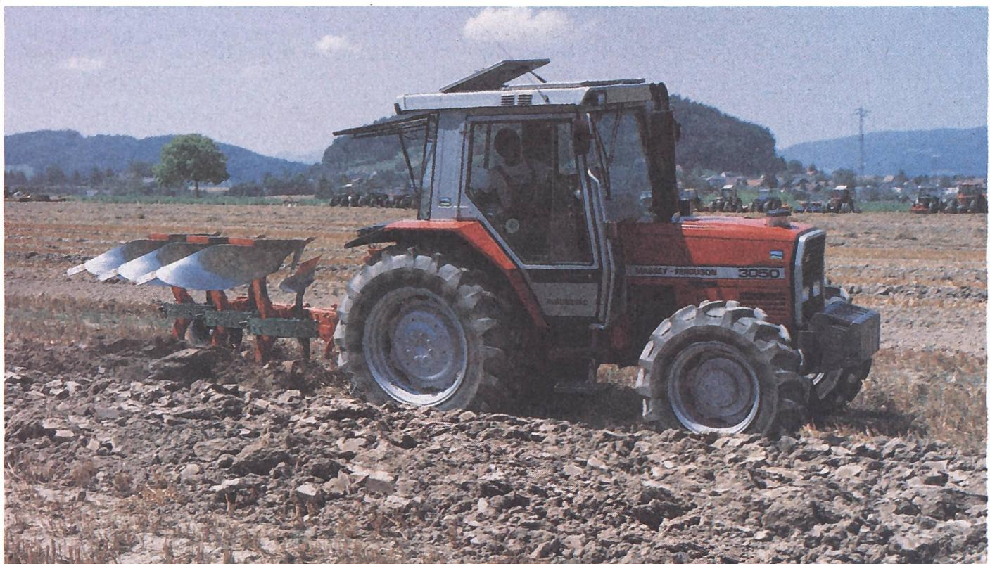
Bei schwerer Zug- und Zapfwellenarbeit sind die Vorteile des Mehrstufen-Lastschaltgetriebes offensichtlich. Unter voller Last können Fahrgeschwindigkeit, Motor- bzw. Maschinenleistung optimal aufeinander abgestimmt und ausgenutzt werden.
