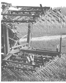
**HARUWY-Hackstriegel** in Arbeitsbreiten von 4,5 m, 5 m, 6 m, 6,25 m, 7,5 m, 9 m, 10,5 m, 12 m. Vergleichen Sie die solide Konstruktion und den günstigen Preis!
